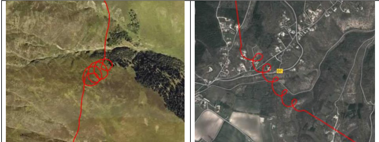
Figure 2. Trace GPS de l'exploitation d'un thermique sans vent (à gauche) et avec vent (à droite).
